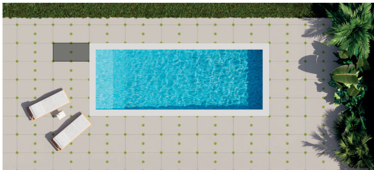
Ejemplo de unidades/pieza y ubicación para formato de pavimento de 60 x 120 cm.
